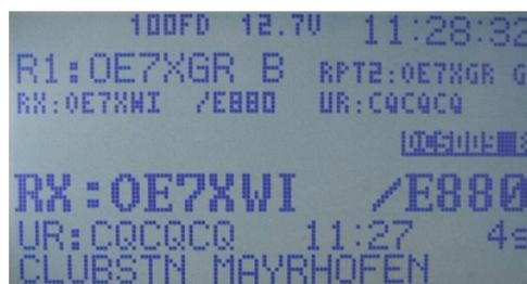
Abbildung 19: Bildschirmseite D-STAR im Reflektorbetrieb
