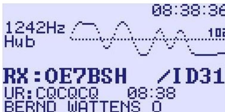
Abbildung 27: Hotspot-Betrieb, Hubanzeige HF-Empfang
