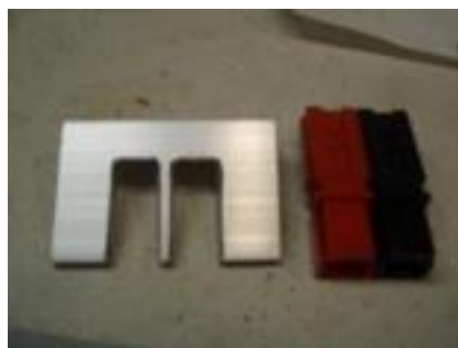
Bild 12 Halterung 2polig Eigenbau noch o.Befestigungslöcher
