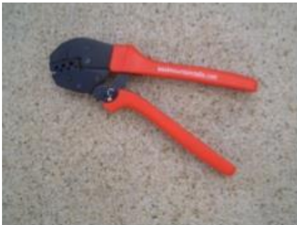
Bild 2 + 3 Krimpzange für 3 Kontaktgrößen 15A, 30A, 45A
