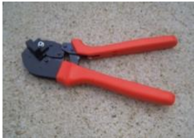
Bild 2 + 3 Krimpzange für 3 Kontaktgrößen 15A, 30A, 45A
