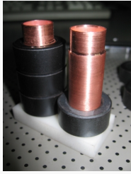
OE1IFM Aufbau Transformator
